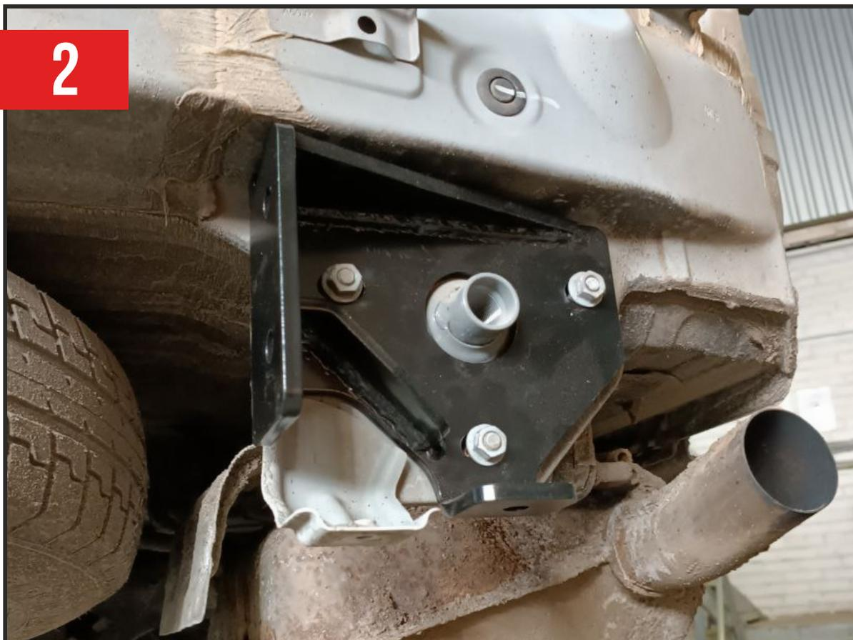
Расверлить отверстие  $d12$  в лонжеронах по месту.
