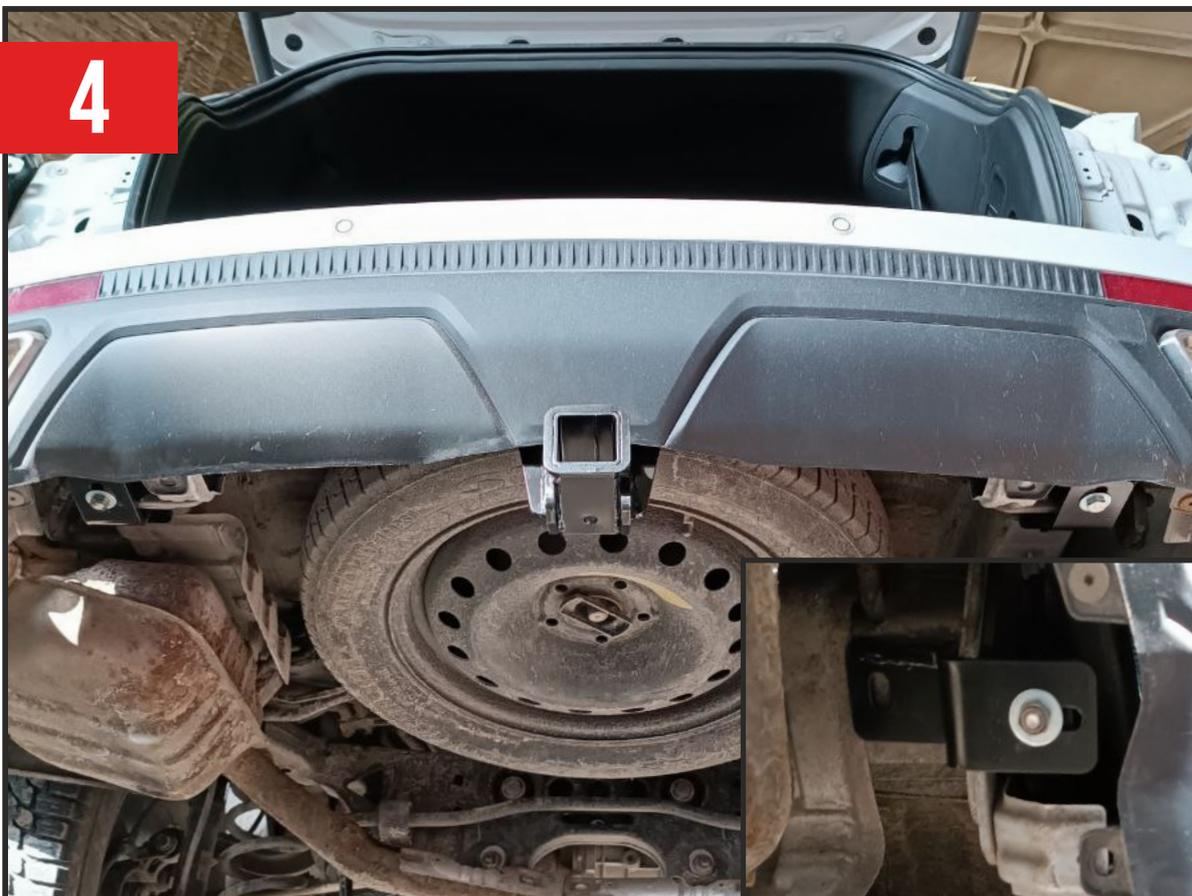
Установить бампер с усилителем на место. Закрепить кронштейны на лонжеронах усилителями «5». Затянуть крепёж.
