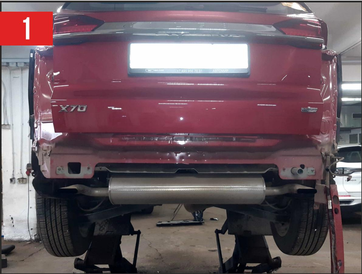
Снять бампер и его усилитель.
